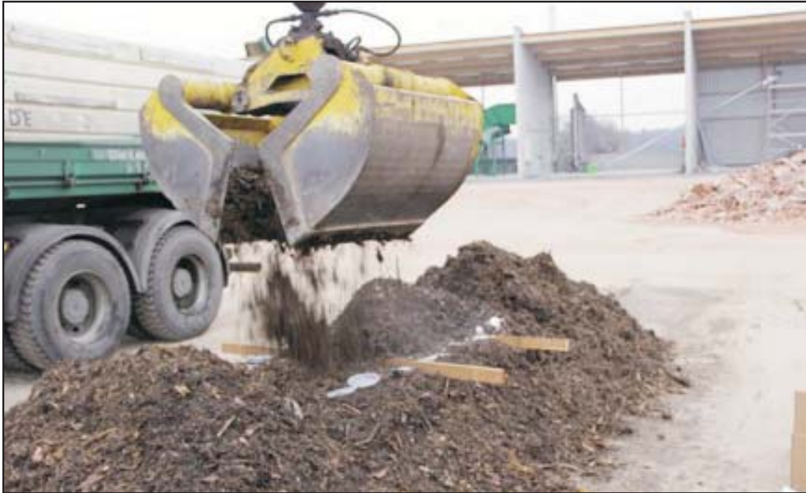
Überdecken der Verpackungen und GOFAIR Trinkbecher mit Kompostmaterial
